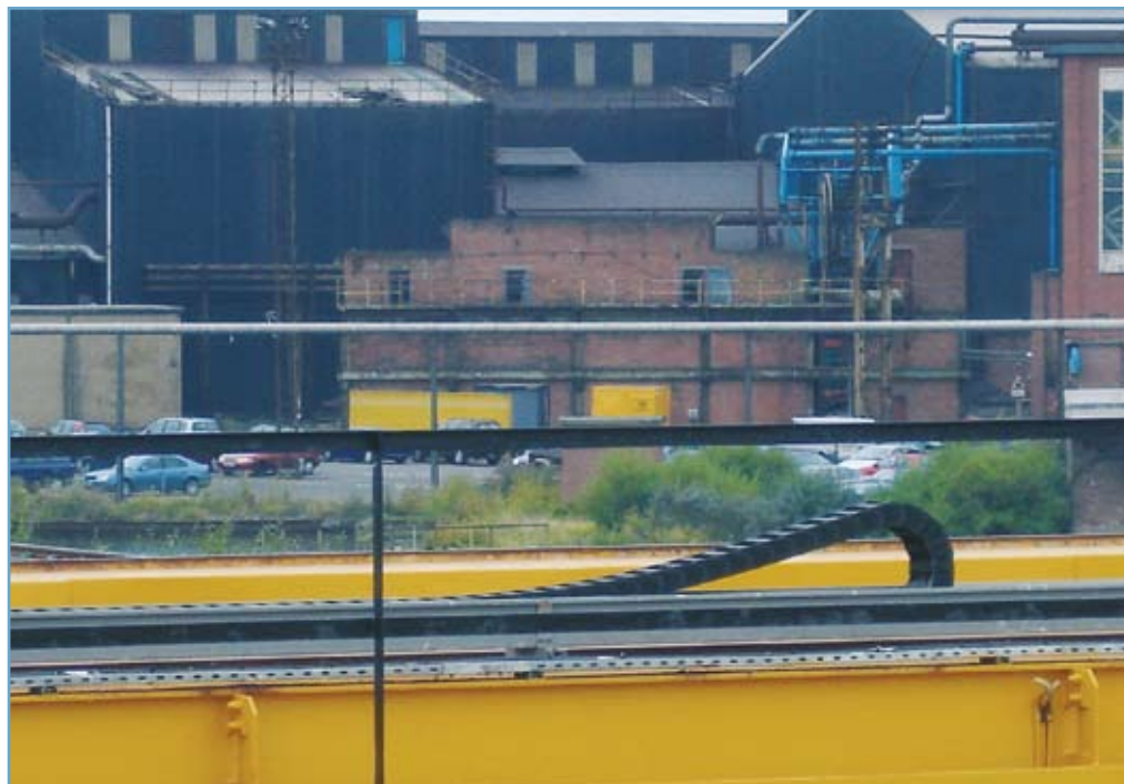
Afbeelding 1. Bij de Corus-staalfabriek in het Engelse Workington zijn de kabelwagens aan zeventien buiten-portaalkranen vervangen door inbouwklaar geassembleerde ReadyChain-kabelrupssystemen.
