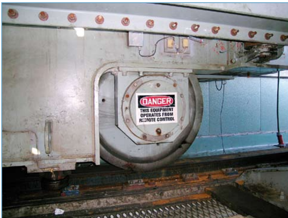
Afbeelding 2 De rijdende onderstellen zijn voorzien van dubbele flenswielen.
