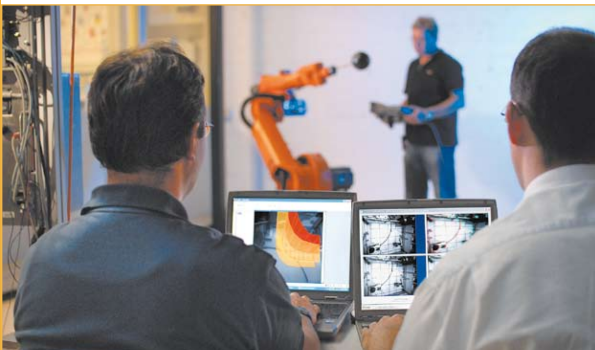
Afbeelding 2. Een proefopstelling van het SafetyEYE camerasysteem bij DaimlerChrysler in Sindelfingen. Het systeem – ontwikkeld door Pilz in samenwerking met DaimlerChrysler – moet dit jaar de productie van de nieuwe Mercedes E-klasse gaan beveiligen.
