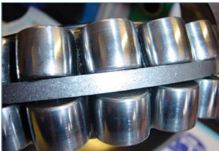
Links de als nieuw ogende rollen van een walslager uit de transportinstallatie van Arcelor, na een jaar zonder nasmering gedraaid te hebben met het HP-smeermiddel Molub-Alloy 777/2. Rechts de rollen van een conventioneel gesmeerd referentielager die, ondanks de acht nasmeerbeurten, getuige het matte oppervlak duidelijk zijn aangetast door slijtage.
