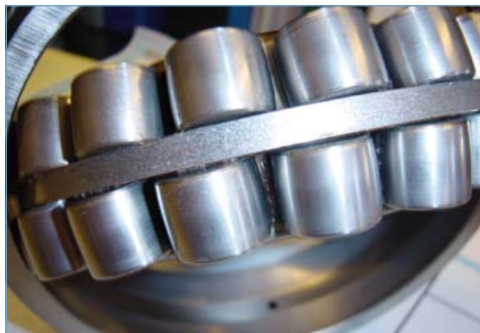
Links de als nieuw ogende rollen van een walslager uit de transportinstallatie van Arcelor, na een jaar zonder nasmering gedraaid te hebben met het HP-smeermiddel Molub-Alloy 777/2. Rechts de rollen van een conventioneel gesmeerd referentielager die, ondanks de acht nasmeerbeurten, getuige het matte oppervlak duidelijk zijn aangetast door slijtage.
