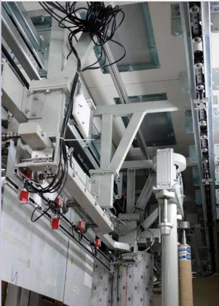
Afbeelding 4 (links). De maskeerinrichting waar de gecoate plaat langs twee rollen met folie wordt geleid.
